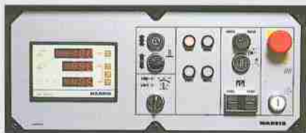
T 251 A Digitalanzeige für Spindelschwenkung, Spindel auf- und ab mit Relativ- und Absolutmaß.
